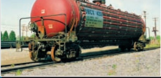
Les éléments ContoTrace montés sur un wagonciterne ont résolu un sérieux problème de maintenance dans le transport de caprolactame.
