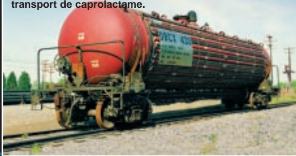
Les éléments ControTrace montés sur un wagon-citerne ont résolu un sérieux problème de maintenance dans le transport de caprolactame.
