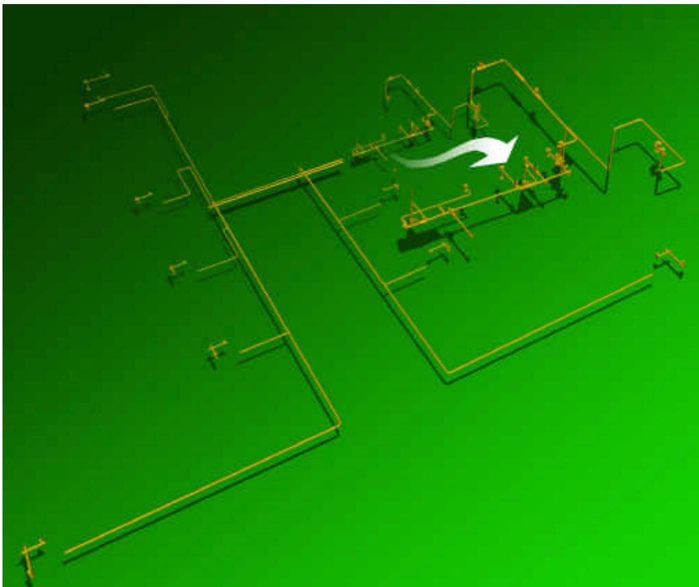
**FIGURE 5 SULFUR RUN-DOWN PIPING AT UPGRADER SRU**
