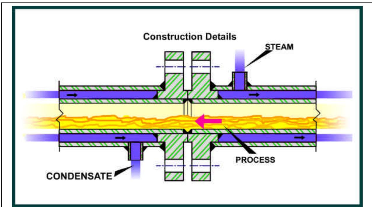
FIGURE 6 TYPICAL JACKETED PIPE FOR SULPHUR RUN-DOWN.
