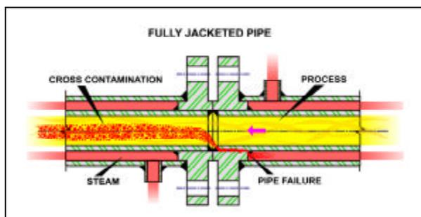
FIGURE 2 STEAM CONTAMINATION OF SULFUR PROCESS
